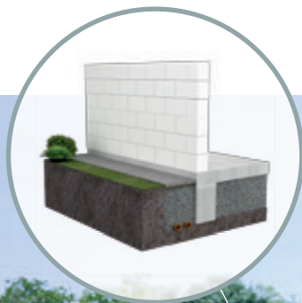
ZÁKLADOVÉ PASY TEPELNĚ IZOLOVANÉ PĚNOVÝM SKLEM A-GLASS
