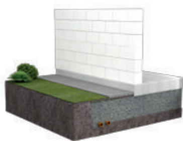
ZÁKLADOVÁ DESKA TEPELNĚ IZOLOVANÁ PĚNOVÝM SKLEM A-GLASS
